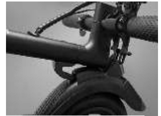
Durch los lassen der Auftrittbremse rastet der Haken ein
