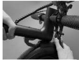
Führe den Haken an der Lenkstange zur Öffnung in der Auftrittbremse und setze ihn an
