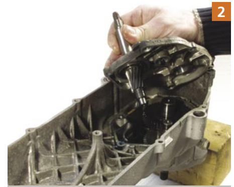
2 Durch Rütteln an der Kupplungswelle kann man den Getriebedeckel lösen und abnehmen.
