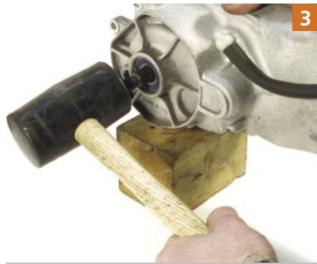
3 Mit einem Gummihammer (!) die Antriebswelle aus dem Lager klopfen. Achtung: auffangen!
