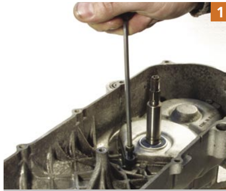
1 Nach dem Abziehen der Kupplung hat man freie Sicht aufs Getriebe. Getriebedeckelschrauben mit 5er Inbusschlüssel lösen.
