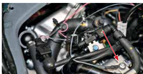
Eine saubere Verlegung und Fixierung der Kabel bewahrt vor Scheuerstellen. Zuletzt die Öse für den Masseanschluss (Pfeil) nicht vergessen
