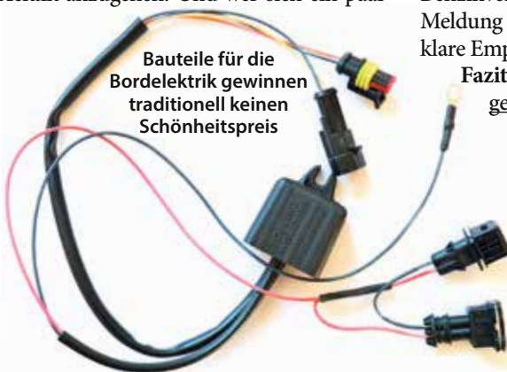
Die Stecker der TC Unit werden zwischen die Anschlüsse von Einspritzdüse und Lambdasonde geschaltet
