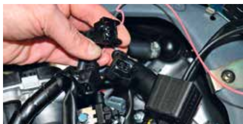
Die Stecker der TC Unit werden zwischen die Anschlüsse von Einspritzdüse und Lambdasonde geschaltet
